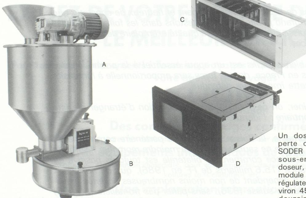
Un doseur pondéral par perte de poids K-TRON SODER se compose de 4 sous-ensembles : A le doseur, B la balance, C le module de puissance, D le régulateur. Un choix d'environ 45 doseurs et d'une douzaine de balances permet de réaliser la configuration exacte de l'application.
