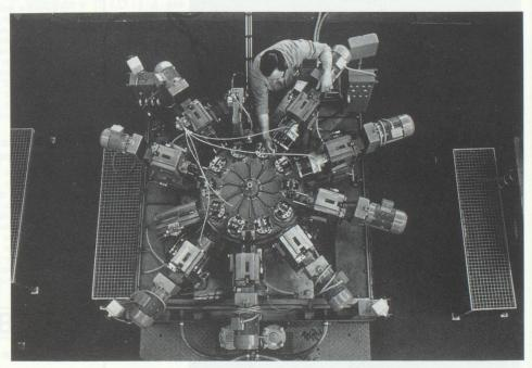
Vue d'une machine transfert équipée d'éléments de serrage inclinables.
