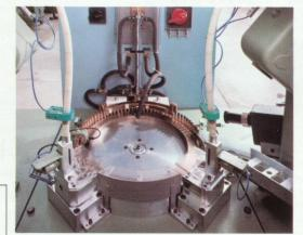
Générateur HF avec poste de recuit pour cartouches (jusqu'à 20 000 pièces à l'heure).
