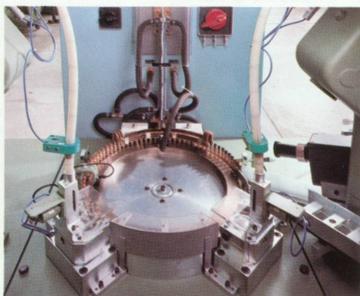
Générateur HF avec poste de recuit pour cartouches (jusqu'à 20 000 pièces à l'heure).
