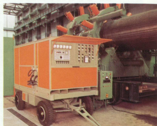
Installation moyenne fréquence mobile pour l'ajustement fretté de garnitures de rotors de turbogénérateurs.
