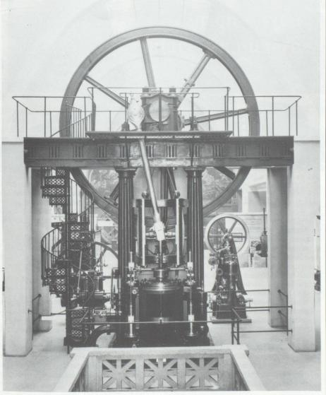
Machine à vapeur Sulzer à commande par soupapes (1863).
