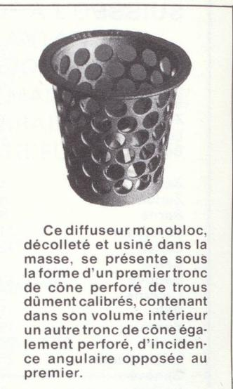
Ce diffuseur monobloc, décolleté et usiné dans la masse, se présente sous la forme d'un premier tronc de cône perforé de trous dûment calibrés, contenant dans son volume intérieur un autre tronc de cône également perforé, d'incidence angulaire opposée au premier.
