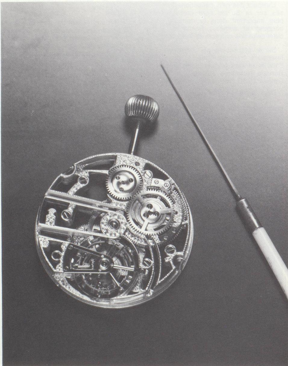
*Mouvement squelette à « Tourbillon ». Le tourbillon est un dispositif imaginé par le célèbre horloger Breguet, en 1801, pour annuler les écarts de marche dans les positions verticales. Une cage mobile renferme tous les organes de l'échappement avec l'organe régulateur et effectue un tour en une minute. Ce mécanisme compliqué compte parmi les plus grandes réalisations horlogères. (Patek Philippe)*
