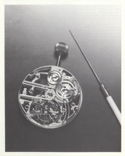
Mouvement squelette à « Tourbillon ». Le tourbillon est un dispositif imaginé par le célèbre horloger Breguet, en 1801, pour annuler les écarts de marche dans les positions verticales. Une cage mobile renferme tous les organes de l'échappement avec l'organe régulateur et effectue un tour en une minute. Ce mécanisme compliqué compte parmi les plus grandes réalisations horlogères.
