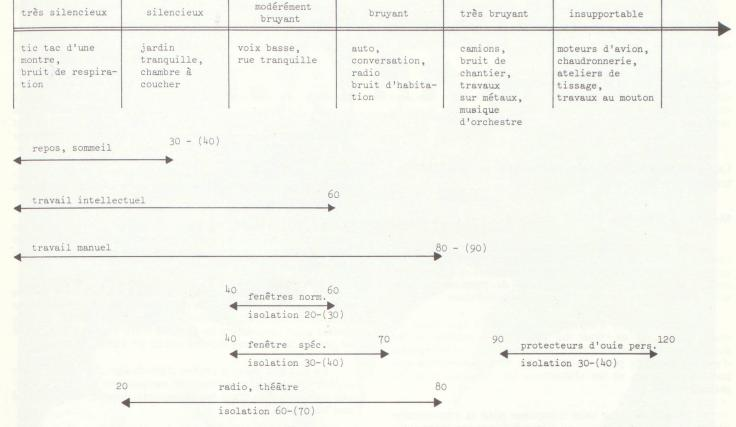
TABLEAU 2: Exemples de niveaux et d'isolations acoustiques
