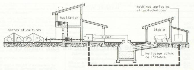
(Production d'énergie électrique et thermique en utilisant le biogaz.)
