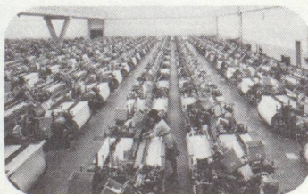
Salle de tissage équipée de machines à tisser à navettes, type Rütli-C1000
