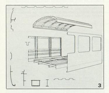
En 1972, les constructeurs du British Rail's Advanced Passenger Train (fig. 4) projettent une fabrication automatisée des caisses de voiture. Alusuisse crée les profilés convenant au soudage à la machine. Les Suisses mettent au point un assemblage soudé bout à bout et auto-centré qui rend superflu l'épinglage indispensable dans le cas des assemblages à recouvrement.
