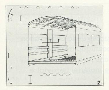
En 1966, les plans établis pour le chemin de fer du Brünig (fig. 3) montrent des sous-ensembles permettant de réaliser d'autres économies de travail d'assemblage. Les avantages du développement technologique gagnent en importance : l'économie de main-d'œuvre ramène le prix du véhicule en aluminium de 1 - 3 % seulement au-dessus de celui de l'exécution en acier. L'économie de poids est, en revanche, de 40 %.
