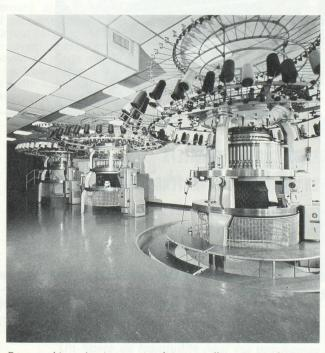
Des machines à tricoter circulaires et d'autres machines et appareils sont mis en service au « Technical Service Center » de Hong-Kong.
