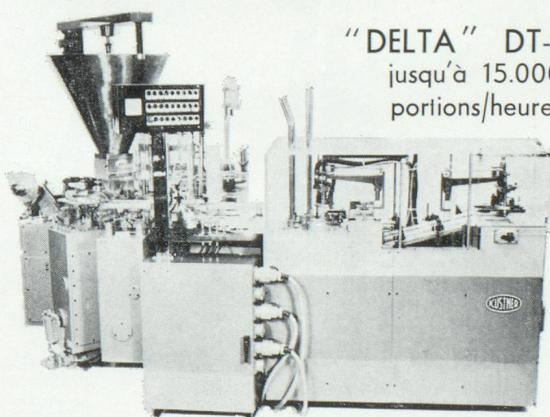
Machines automatiques pour la préparation et l'emballage du fromage fondu. Mouleuses, emballageuses automatiques pour le beurre, la margarine et autres produits pâteux.
