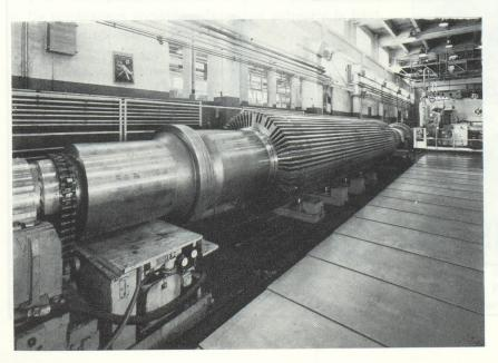
Fig. 3. — Rotor de l'alternateur en cours de rainurage.
