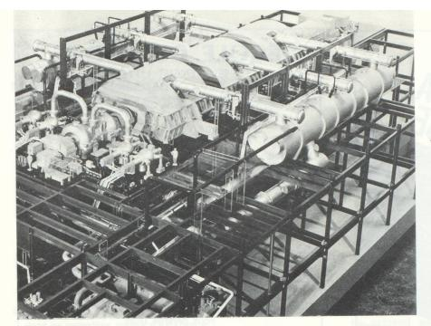
Fig. 1. — Maquette du groupe turbo-alternateur de 1 250 MW à 1 800 tr/mn, de la centrale nucléaire à eau légère de Forked River aux Etats-Unis.
