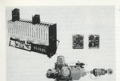
Air Équipement /D.B.A. Dispositif de sensation artificielle Concorde.
