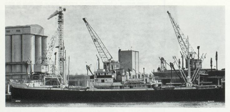
Dans le port de Rouen : Tous les transporteurs à chaîne du silo de 20 000 t du Port Autonome (à gauche) ont été fabriqués par BUHLER. Trois portiques ayant chacun une ligne SKT/BKT de  $150 \, t/h$  servent au déchargement et au chargement de bateaux. Un portique de  $300 \, t/h$  est encore en cours de montage pour le chargement de bateaux. Trois autres dispositifs SKT de  $150 \, t/h$  chacun sont à disposition pour le déchargement et le chargement de barges.
