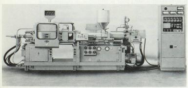
Machine automatique à injecter les thermoplastiques Neomat 150/60 Fabrique de machine et Fonderie Netstal SA. Netstal
