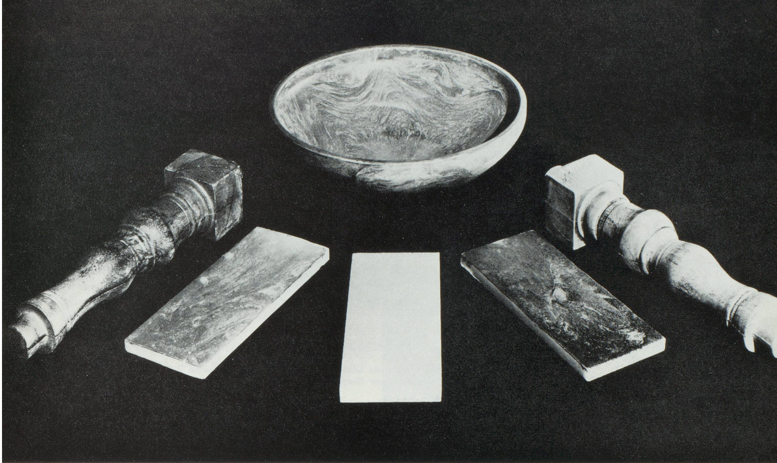
Extrusion Celuka et injection Lorkacel (Photo C. Bazin-Ugine Kuhlmann)
