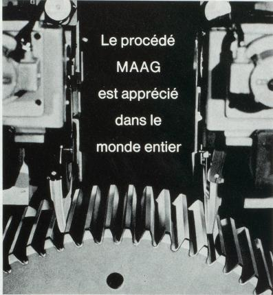
MAAG construit des machines capables de rectifier des engrenages jusqu'à 4600 mm de diamètre, avec toute la précision requise et les corrections indispensables pour répondre aux plus fortes sollicitations, atteintes dans la plupart des systèmes de transmission modernes.
