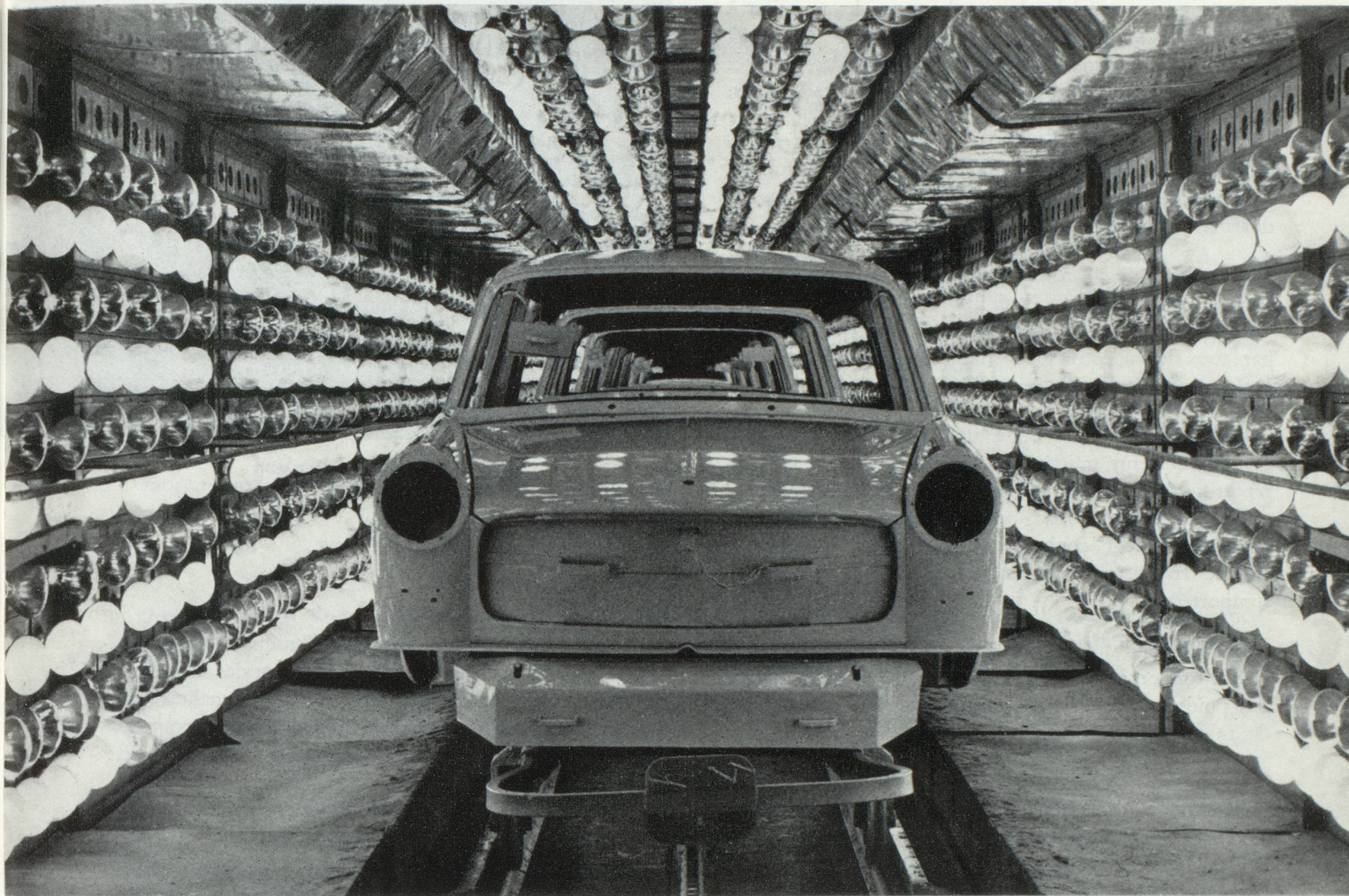
Carrosserie : un tunnel de séchage aux infra-rouges (Société industrielle et commerciale des automobiles Peugeot, Sochaux)
