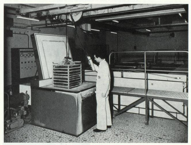
Installation de surgélation de plats ¿cuisinés d'Air France à Orly. Au premier plan, le congélateur à azote liquide dans lequel on introduit un panier supportant les plats cuisinés. Au second plan, l'enceinte de stockage à — 50 °C, refroidie à l'azote liquide.
