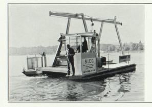
Bateau-nettoyeur des plans d'eau destiné au ramassage de toutes sortes de corps des lacs, retenues et cours d'eau
