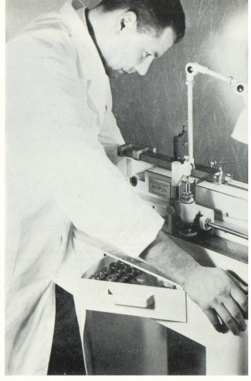
Dans le cadre de l'« aide technique aux fabricants », le CTM dispose d'appareils spéciaux tels que le technographe ci-dessus servant à l'étude des ressorts.
