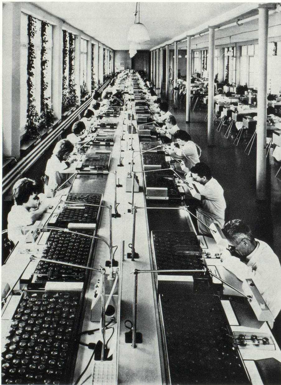
Voici une « chaîne de remontage » des montres. Plusieurs postes individuels servent chacun à une opération différente, il n'y a pas de « ruban continu ». Cent mouvements, contenus dans un boîtier à couvercle transparent, viennent se placer un à un devant l'horloger, sur commande de ce dernier. L'horloger peut choisir le rythme de travail qui lui convient. La série terminée, le boîtier est transmis au prochain poste de travail.
