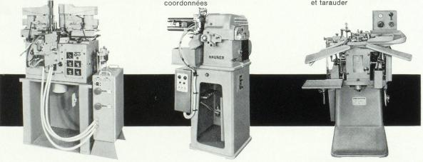
543 Machine automatique à fraiser et percer à 3 broches verticales
