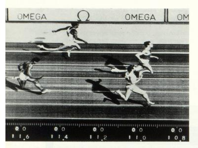
Grâce au Photosprint, une photo agrandie est à disposition du jury 60 secondes après la fin de la course. En tirant une ligne tangente au torse du coureur, on peut facilement lire les résultats sur l'échelle des temps.
