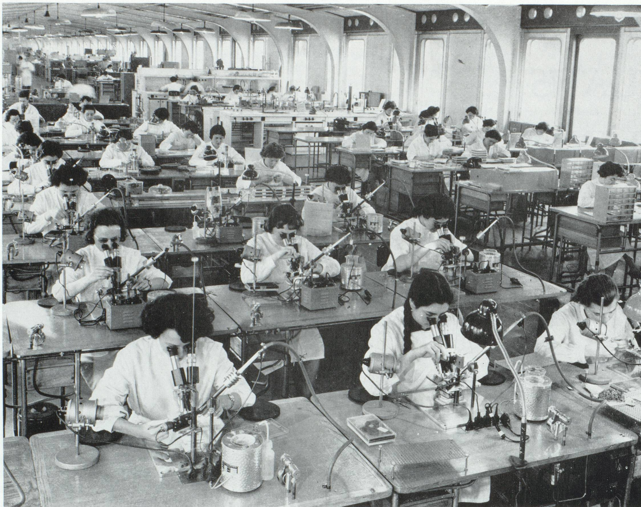
EXIGENCES DES TECHNIQUES. Dans cet atelier d'une usine française de matériels électroniques, les transistors en sont à un stade de micro-miniaturisation tel qu'ils doivent être montés sous microscope. L'évolution des techniques est, en ces domaines, si rapide qu'elle provoque le rapprochement des entreprises pour assumer les frais et mettre en commun les résultats des activités de recherche.
