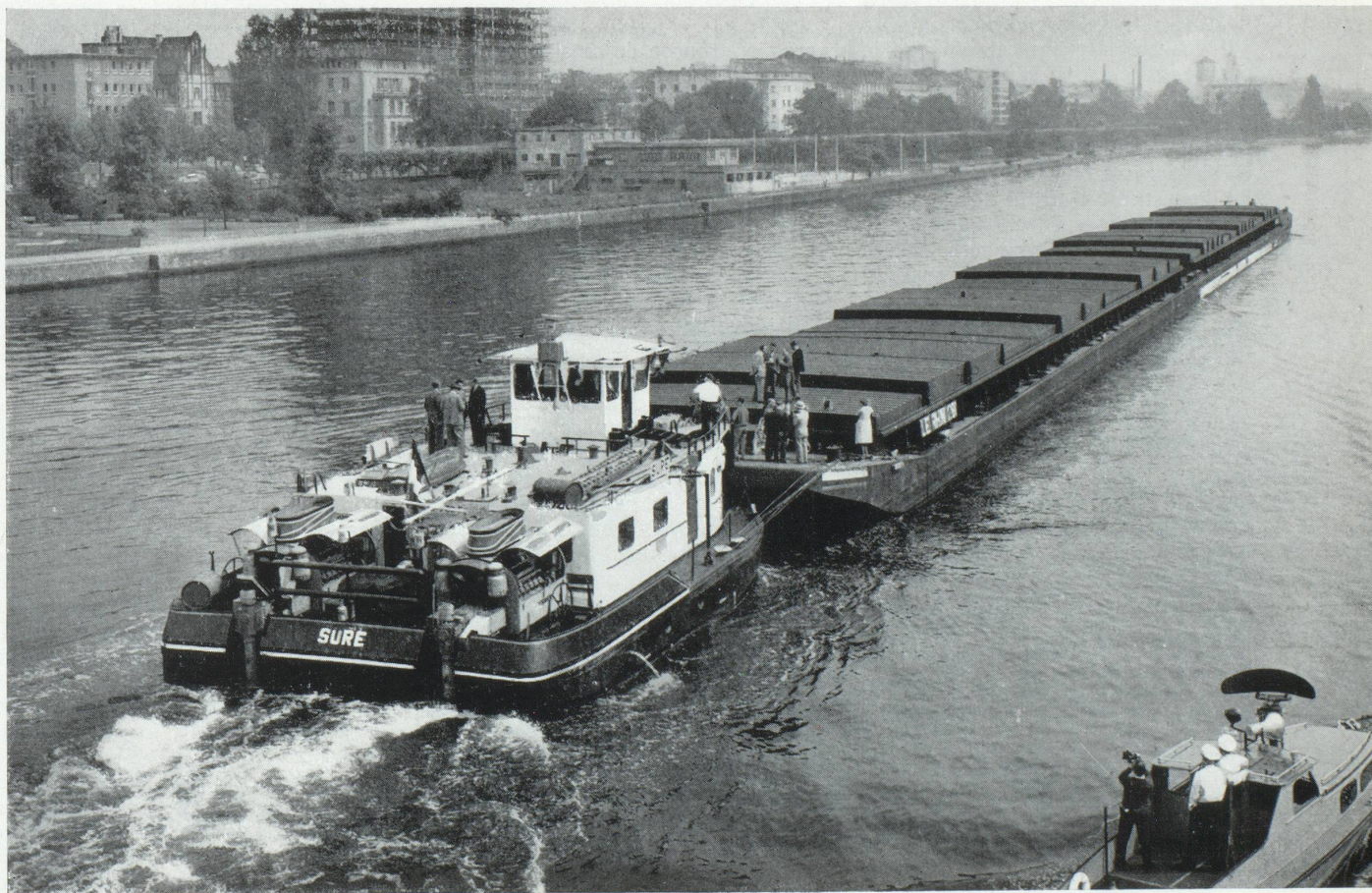
LE POUSSEUR « SÛRE » (750 CV) TRAVERSE FRANCFORT EN POUSSANT DEUX BARGES COUVERTES
