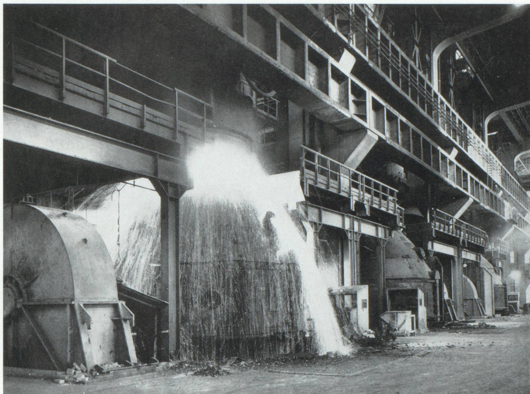
Acierie O. L. P. à l'oxygène pur : trois convertisseurs dont un en soufflage.
