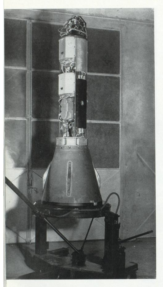
L'extrémité avant de l'engin est constituée d'une ogive expérimentale de 403 kilogrammes, qui se compose d'un revêtement extérieur type « Ablation », à deux couches de matériau stratifié, d'un conteneur pour logement du matériel d'expérimentation, d'une soute à parachutes de récupération équipée.
