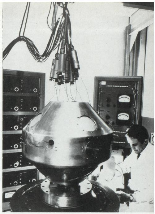
Le premier satellite technologique, qui sera lancé par la Délégation Ministérielle pour l'Armement pour la mise au point du lance-satellite Diamant. Vue du satellite en essai sur table vibrante à la Société M.A.T.R.A.
