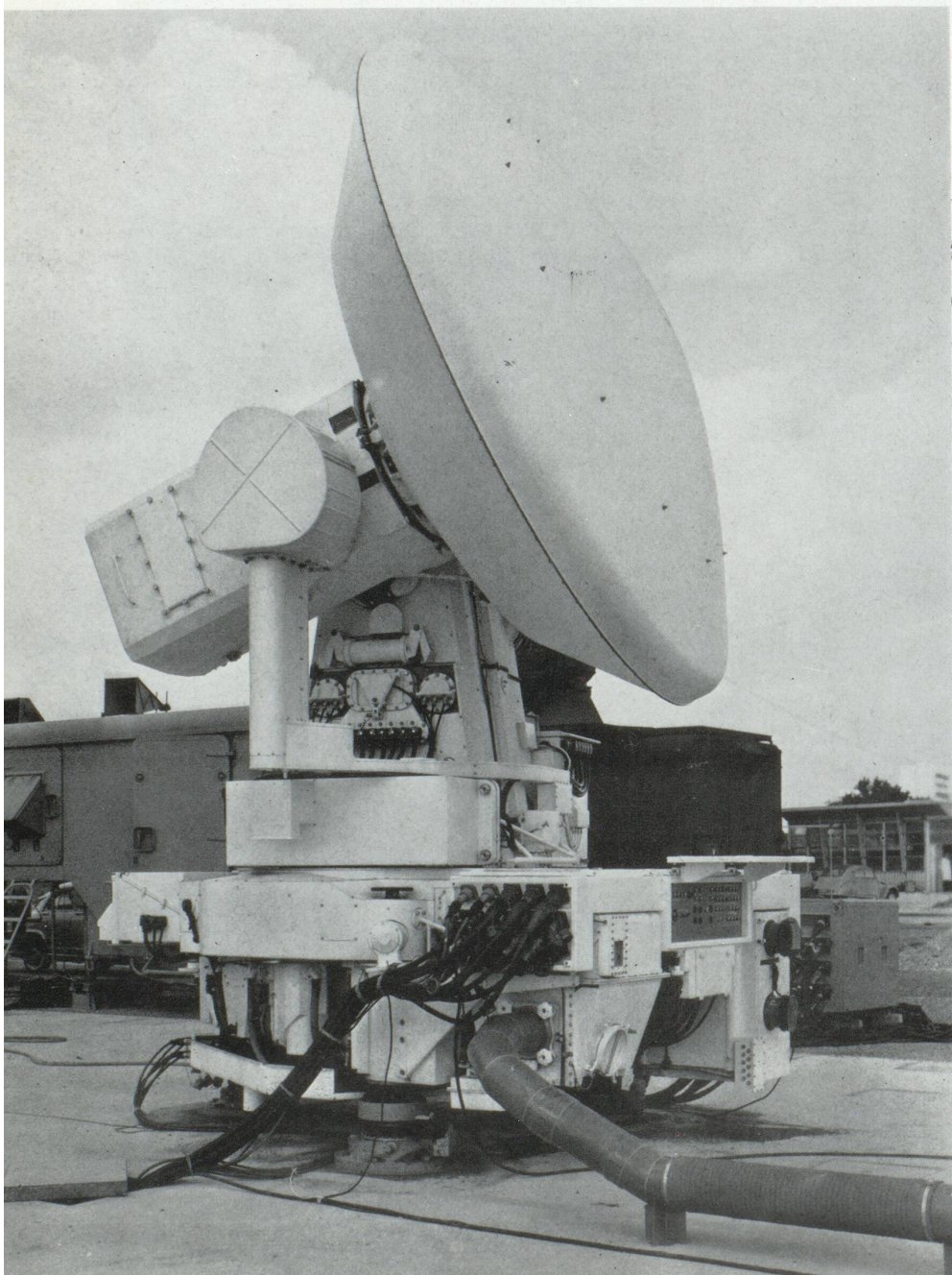
Le radar Aquitaine construit par la Compagnie Française Thomson-Houston pour la Délégation Ministérielle pour l'Armement : ce radar peut suivre les mobiles avec précision jusqu'à 2 300 kilomètres de distance.
