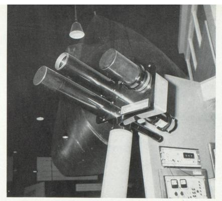
Télémètre optique à laser, utilisant un laser pour la mesure des distances, de la Compagnie Générale d'Électricité.
