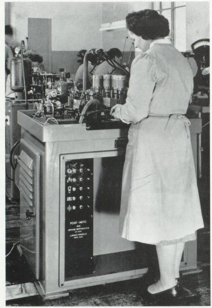
Fabrication des cartouches. Usinage complet des pointes de cartouches.
