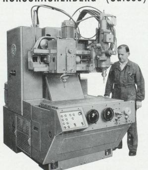
Fraiseuse hydrocopiante AUTOMATIQUE à banc fixe LA RIGIDE originale, type KAB-50 avec dispositif de profilage automatique 360° et copiage avec inverseur, table | 100 × 500 mm.
