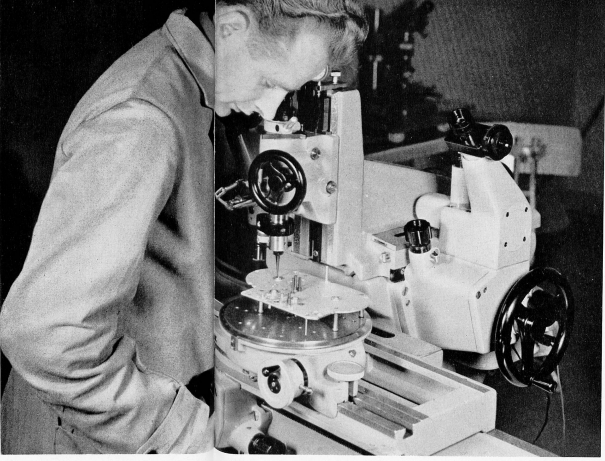
A gauche : Redivisage d'un mètre-prototype sur machine à diviser de la Société d'Instruments de Physique de Genève. C-dessus : Contrôle au 1/1000 mm d'une plaque de cambre. Machine à injection pour les matières thermoplastiques (Paillard).
