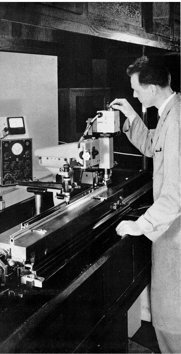
A gauche : Redivisage d'un mètre-prototype sur machine à diviser de la Société d'Instruments de Physique de Genève. Ci-dessus : Contrôle au 1/1000 mm d'une platine de caméra. Machine à injection pour les matières thermoplastiques (Paillard).
