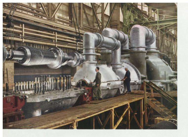
Ci-dessus : cette turbine de 175 000 kW, à 3 000 t/mn, destiné à la centrale d'Amer de la Provinciale Noordbrabantsche Electriciteits Mij., à Geertruidenberg (Pays-Bas), est une des plus grandes turbines à vapeur construite par le groupe Brown Boveri. On la voit ici sur la plate-forme d'essai des ateliers à Baden, avec le corps haute pression en montage.
