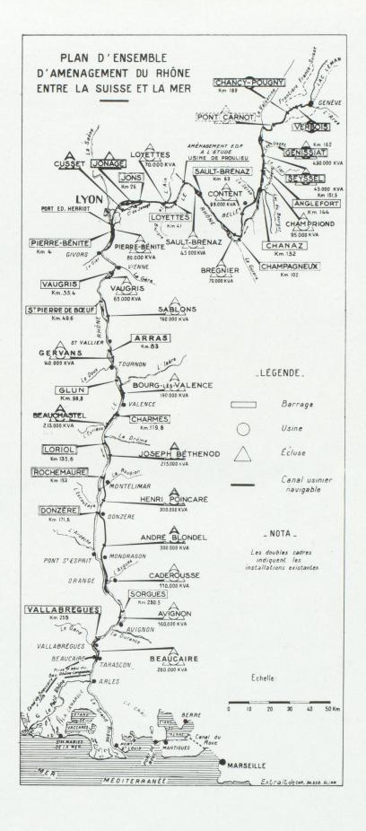
créée par un barrage à vannes mobiles qui alimente un canal de dérivation plus ou moins long, suivant les circonstances géographiques : c'est sur ce canal que se trouvent l'usine et l'écluse, ouvrages au droit desquels la chute utile est concentrée.
