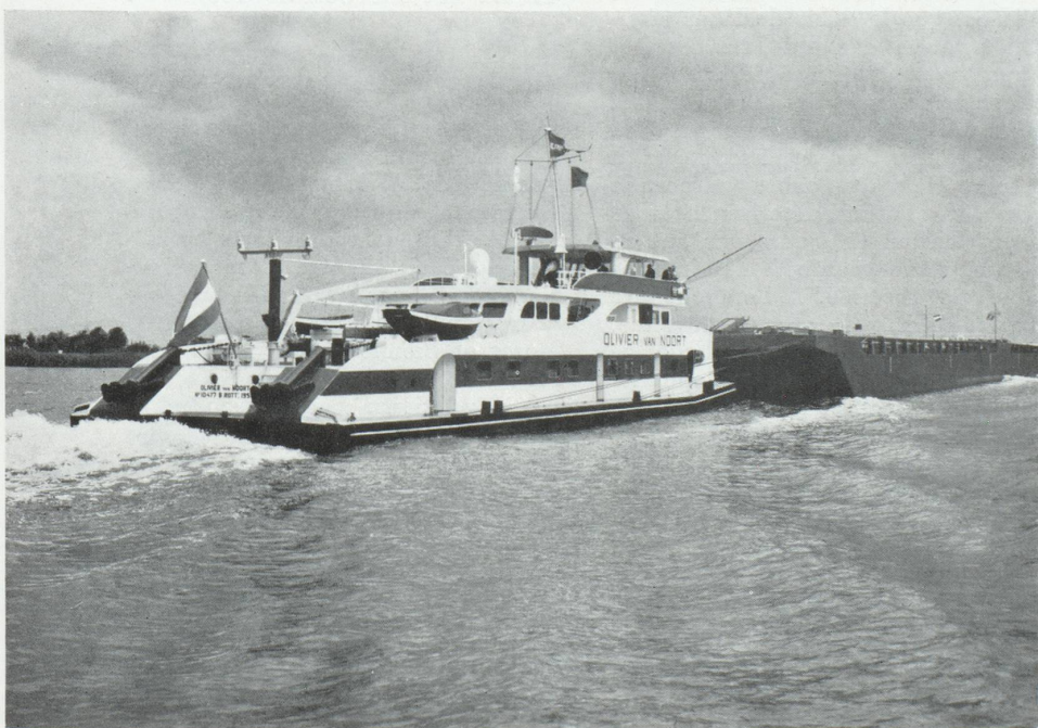
La nouvelle technique du « poussage » vient des Etats-Unis où elle est utilisée depuis longtemps. Ici le premier convoi poussé arrivé à Bâle.
