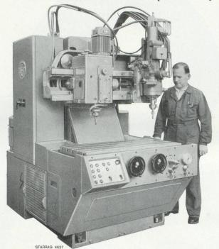
Fraiseuse hydrocopiante AUTOMATIQUE à banc fixe LA RIGIDE originale, type KAB-50 avec dispositif de profilage automatique 360° et copiage avec inverseur, table l 100  $\times$  500 mm.
