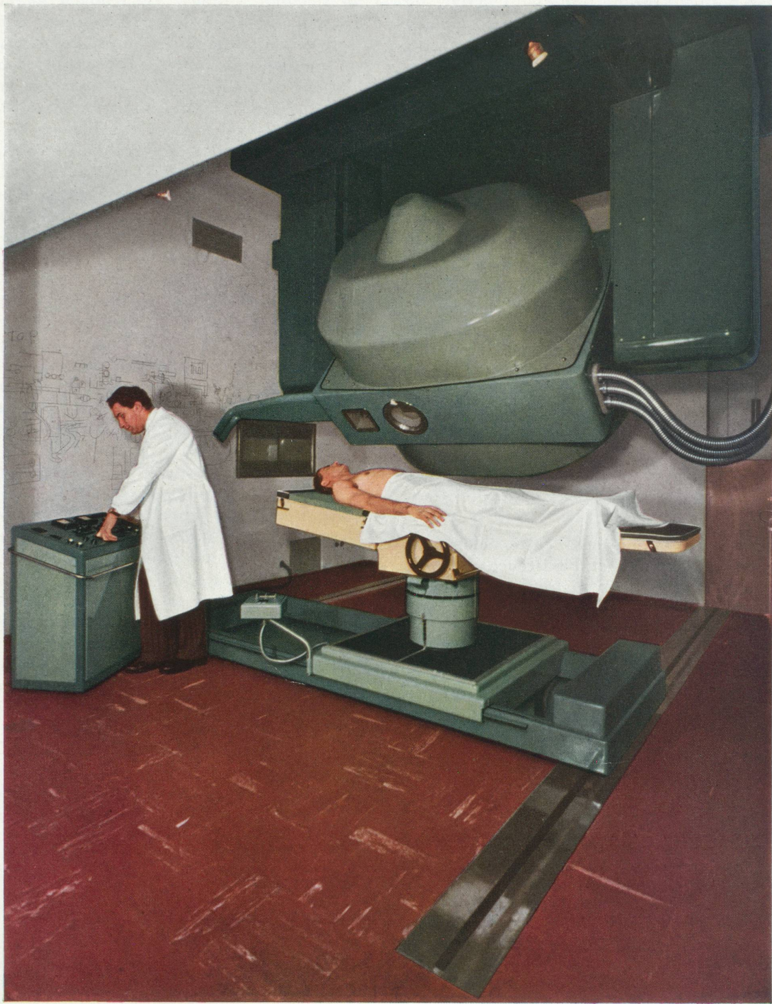
La clinique Saint-Ambroise de Milan est équipée d'un asclépitron Brown Boveri de 31 MeV. L'asclépitron est un béatatron orientable spécialement conçu pour la radiothérapie. Il peut produire soit un faisceau de rayons X de 31 MeV, soit un faisceau d'électrons de 30 MeV. Il est complété par un tube à rayons X de 125 keV, pour le diagnostic, et par une table d'exposition dont la position est réglable à l'aide de servo-moteurs.
