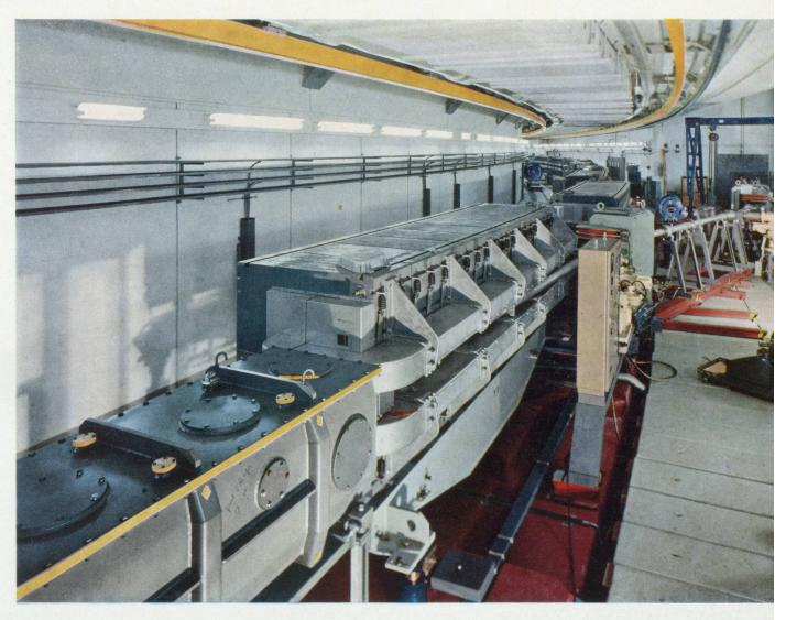
Vue du tunnel circulaire du synchrotron à protons de 25 GeV. On voit, au centre de la figure, l'un des cent éléments de l'électroaimant de guidage dont l'équipement d'alimentation a été construit par la Société Brown Boveri. La photographie a été prise à l'endroit où les protons venant de l'accélérateur linéaire, à droite, sont injectés dans le synchrotron.
