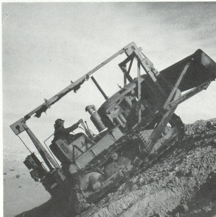
Un système de chenilles très allongées donne au bulldozer une extrême stabilité (Cliché B. R. P.)
