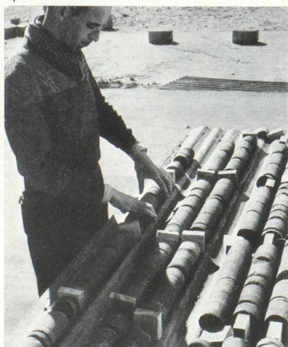
Base de la S. N. Repal à Hassi Messaoud : classement des « carottes » par le géologue (Cliché B. R. P.)
