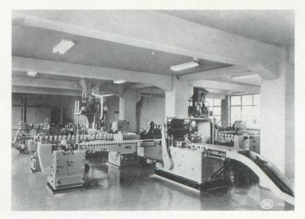
Chaîne d'empaquetage moderne pour sucre cristallisé. Au fond, à gauche : groupe de conditionnement SIG type KFAS pour paquets de I kg, débit 65 paquets /minute. Au premier plan, à gauche : peseuse électronique de contrôle SIG; à droite, fardeleuse pour 10 paquets de I kg, débit 6 paquets par minute.
