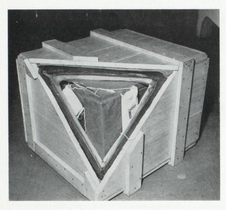
Exemple d'emballage moderne d'expédition sous caisse en bois, faisant appel à des matériaux de protection et à des produits déshydratants.
