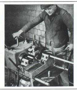
Appareils et Machines à fileter les tubes
