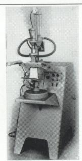
Machine automatique à mettre le lait en sachet polyéthylène hermétiquement fermé
