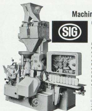
Machine à ouvrir, remplir et fermer les sacs type »**BBS**«
