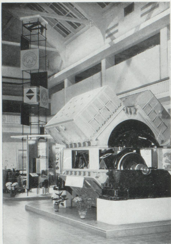
Vue partielle de l'offre si diverse présentée par l'industrie électro-technique. Un compresseur à air pour mines, au premier plan. (Photo Zimmermann.)
