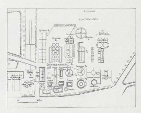
Fig. 5 : Schéma général de la station de traitement de Colombes.
