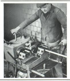
Appareils et Machines à fileter les tubes
