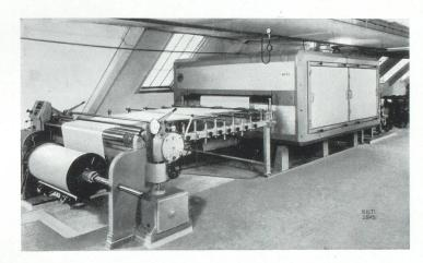
En plus nous livrons la plus petite encolleuse LSMAK (avec sécheur monoplan) qui est également — par rapport à son domaine d'application — une machine très productive pour une fabrication rationnelle.
