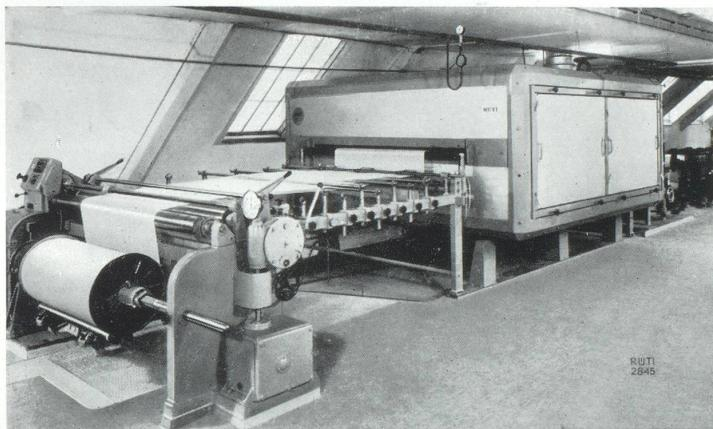
En plus nous livrons la plus petite encolleuse LSMAK (avec sécheur monoplan) qui est également — par rapport à son domaine d'application — une machine très productive pour une fabrication rationnelle.
